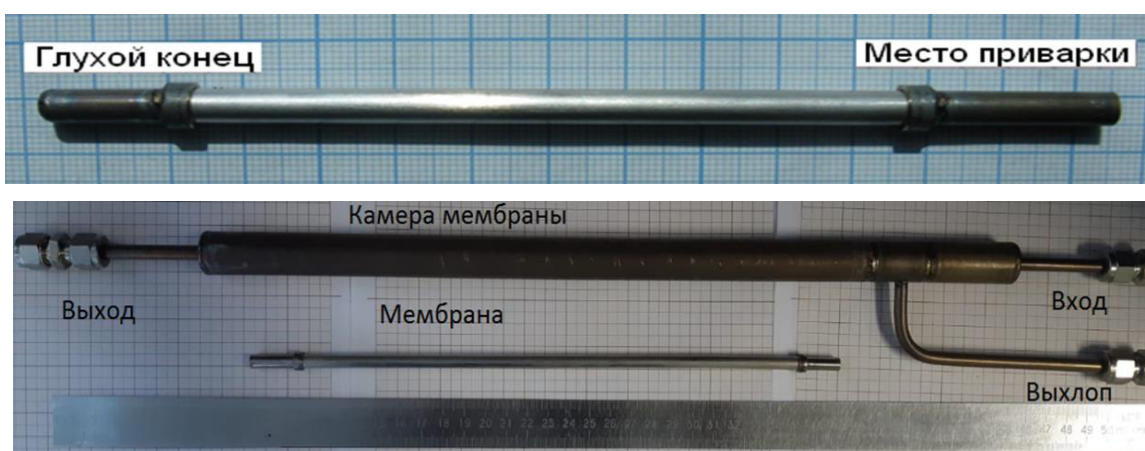
Рисунок 3 - Образец трубчатой мембраны и камера, в которую монтируется испытуемый образец.
